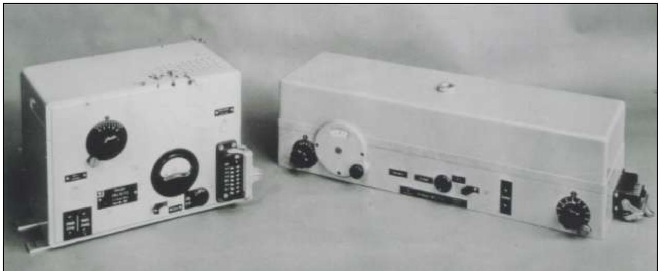
Dieses Bild<sup>2</sup> zeigt den Sender und den Empfänger von Krabbe. Die Geräte werden im Einsatz direkt an der Rückseite des Antennenkastens unter einer Schutzhaube angebracht. Verluste in den Antennenkabeln werden so vermieden und die gesamte Sende- und Empfangsleistung kommen der Übertragung zugute. Ausgangspunkt der Entwicklung waren Laborgeräte aus dem Jahre 1940, die
