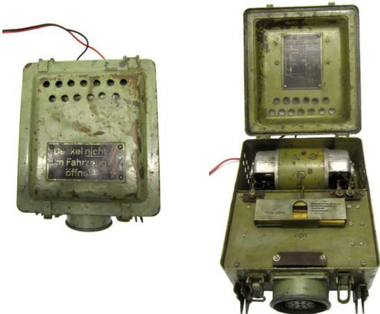
***Der Umformer U30c: Links mit geschlossener Abdeckung, rechts geöffnet mit Blick auf den Generator***
