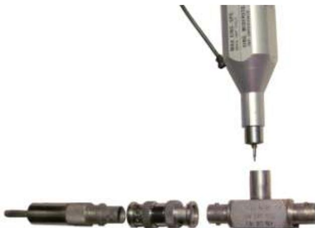
**Explosionsdarstellung für die Messung der HF-Ausgangsspannung**
