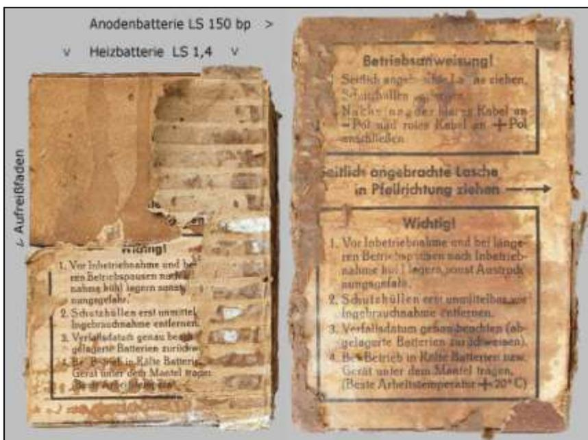
Das Bild unten links zeigt die Oberseite der Transportkiste mit den Beschriftungen 'Anodenbatterie LS 150 bp' und 'Heizbatterie LS 1,4'. Rechts zeigt die Unterseite die originalen Packzustand der Batteriepakete mit den Aufreißfäden. Die Packung ist mit einer Holzleiste zur Luftverdrängung belegt, die aber wie der Deckel mit der Zeit verrottet ist.
