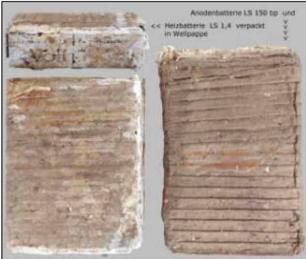
Das Bild oben links zeigt die Oberseite der Transportkiste. Rechts zeigt die Unterseite den originalen Packzustand der Batteriepakete: zwei Pakete jeweils mit Anoden- und Heizbatterie liegen dreifach gestapelt flach, daneben zwei hochkant. Anoden- und Heizbatterie liegen dabei immer hintereinander.
