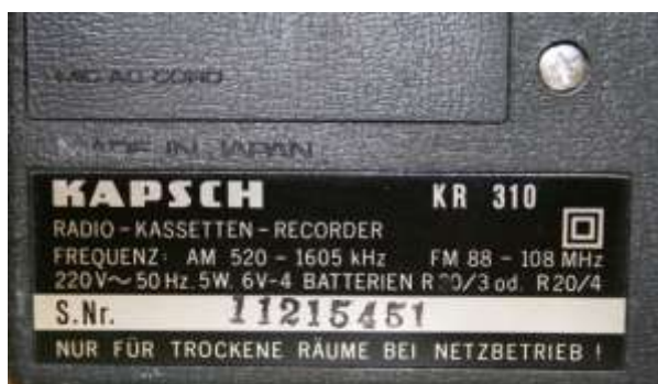
Typenschilder des KAPSCH KR 310 und KAPSCH KR315 sowie ein Detail auf der linken Geräteseite beider Modelle
