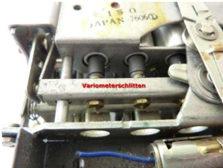
Bild oben: Variometerschlitten mit den Messingschrauben zur Justierung der Kerne
