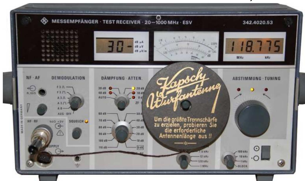
Die KAPSCH Wurfantenne – ein innovatives Produkt der Firma KAPSCH für Radiosammler. Damit konnte ich an meinem R&S Empfänger sofort den Flugfunk auf ca. 118 MHz einwandfrei empfangen. Nicht immer ist eine gestockte logarithmisch-periodische Antenne erforderlich. Durch empirische Versuche ermitteltes Trennschärfe-Maximum liegt bei 3,7483625 m Antennenlänge (Sammlung S. Juster)
