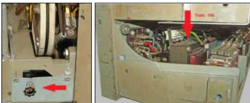
Telefunken-Siegel verdecktes Potentiometer „103“ für die Grobeinstellung der Rückkopplung im ZF-Audion und im unteren Block linke Seite ein Trafo „106“. Beide fehlen in späteren Gruppen. Die
