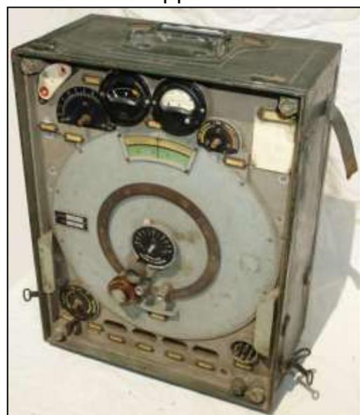
Hier einige besondere Merkmale: Im Gerät befinden sich mehrere rote Siegelmarken „Zaristisches Bulgarien, Ingenieursabteilung“. Die Skala reicht von 3000 bis 5000 kHz und hat eine mitlaufende Gradskala von 0 bis 350°. An der oberen Baugruppe rechte Seite (v.h.g.) befindet sich ein mit dem
