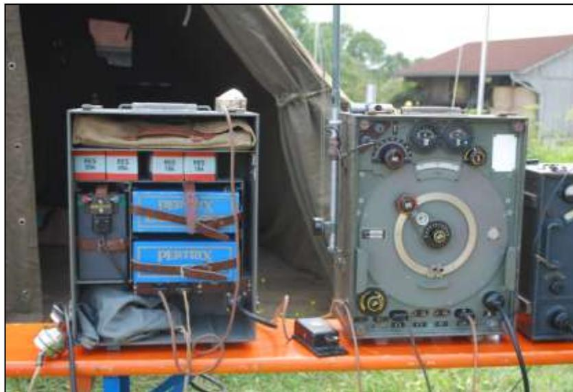
passt in das von Telefunken über alle Geräte hinweg fortlaufende Nummernsystem. Der Tornisterempfänger Spez. 445b Bs des Baujahrs 1936 hatte auch Nummern der Serie 30000. Das Gerät ist ohne Potentiometer 103 und Transformator 106, hat aber das Relais 106 und den Lederriemen am Deckel. Aber: Die tschechoslowakische Armee
