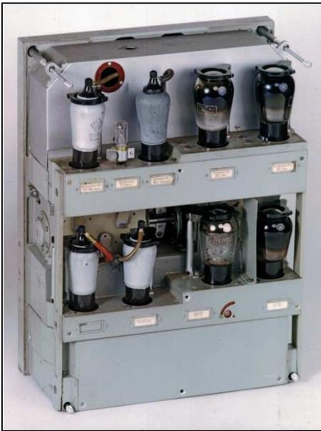
Antennenkreis von Sender und Empfänger in der Mitte, ist HF-Vorstufe und selbstschwingende Mischstufe nach links, PA und VFO nach rechts. Im oberen Block folgen v.l.n.r. ZF-Verstärker, ZF-Audion, NF-Verstärker und Mithör- bzw. Modulations-Stufe. Die Tetroden RES 094 spez. und RES
