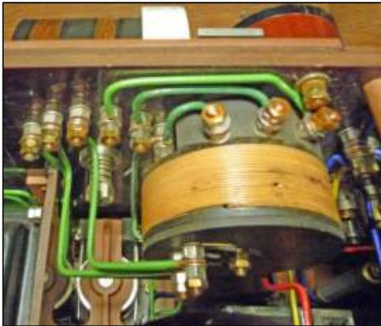
Hier zwei konstruktive Details: die Antennenverlängerungsspule und der mechanische Antrieb des Wellenmessers.
