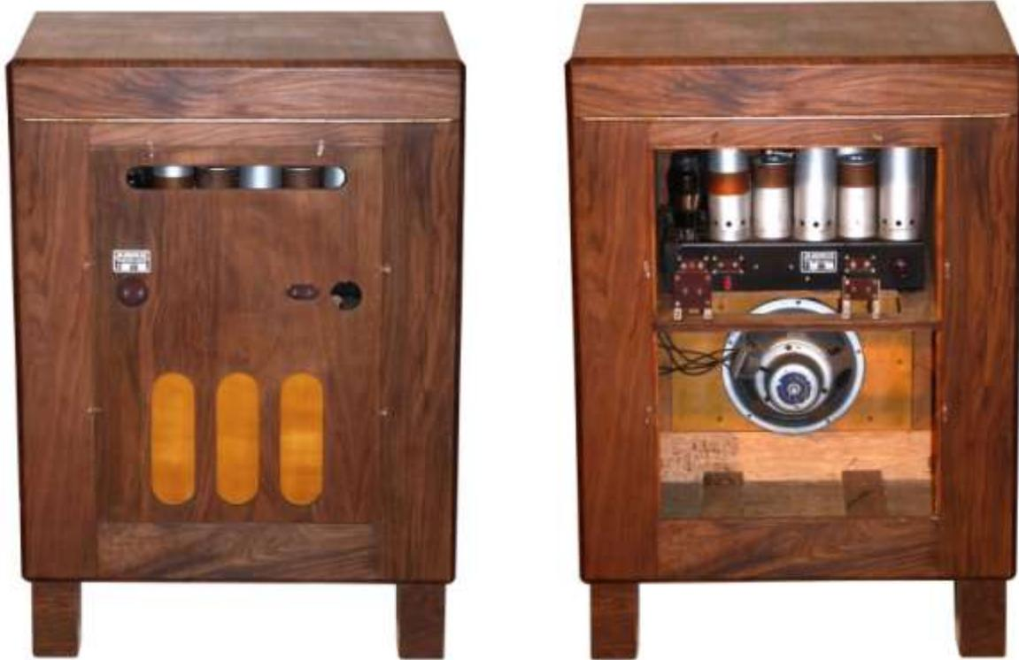
***Rückansicht mit montierter Rückwand (li.) und Blick in das offene Gehäuse (re.) mit dem Radiochassis und Lautsprecher***
