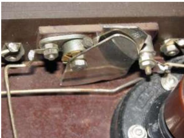
1997 wurde eine hundertprozentige A415 eingesetzt und das Neutrodon der Hochfrequenzstufe laut Gebrauchsanweisung abgeglichen. Danach reichte eine Spannung im einstelligen Millivoltbereich, eingespeist über eine Kunstantenne in die A2- und E-Buchse, für Lautsprecherempfang in Zimmerlautstärke (50 mW). Ein Versuch, den Sender Budapest (540 kHz) mit 1 m Antenne zu empfangen, blieb jedoch erfolglos.
