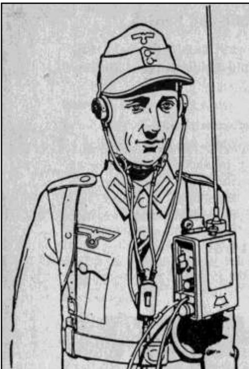
Die linke Seitenfläche hat eine Riemenklemme zum Befestigen am Y-Riemen, die auch das Zusammenschieben mit dem Batteriekasten ermöglicht. Eine flache Abdeckschraube gestattet Zugang zur Frequenzeichnung. Auf der rechten Seitenfläche sind Bedienungsanleitung und Skala.
