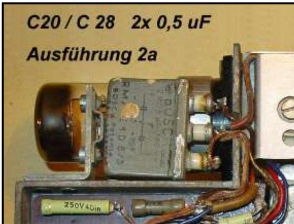
Nebstehendes Bild zeigt die Position von C20 / C28 auf einem Winkel neben der Röhre DDD25 in Ausführung 2a. Ein Gerät aus allerletzter Produktion in Ausführung 2b zeigt C7\* (0,5 µF) und C20 auf der Unterbaugruppe. Hier ist auch der schwarze Elko C27 50 µF aus einer Verlagerungsproduktion mit dem unbekanntem Fertigungskennzeichen „scm“ zu sehen.
