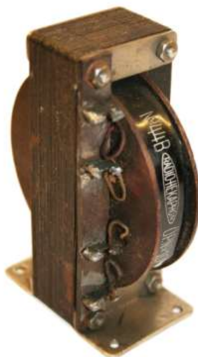
Übertrager Czeija, Nissl & Co., Radio Hekaphon, Type 44B, Übersetzungsverhältnis 1zu4, Primär 4500 Windungen., Sekundär 17.000 Windungen (Sammlung Erwin Macho)
