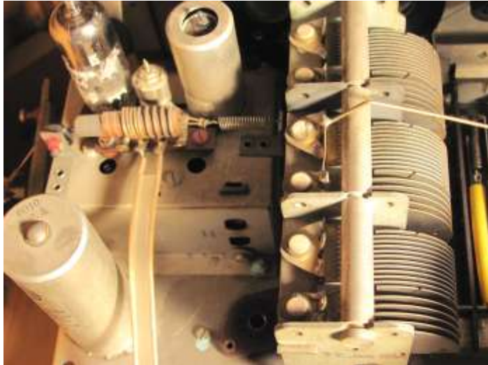
Oben: Sechsfach-Drehko und induktiv abstimmbarer UKW-Eingangskreis
