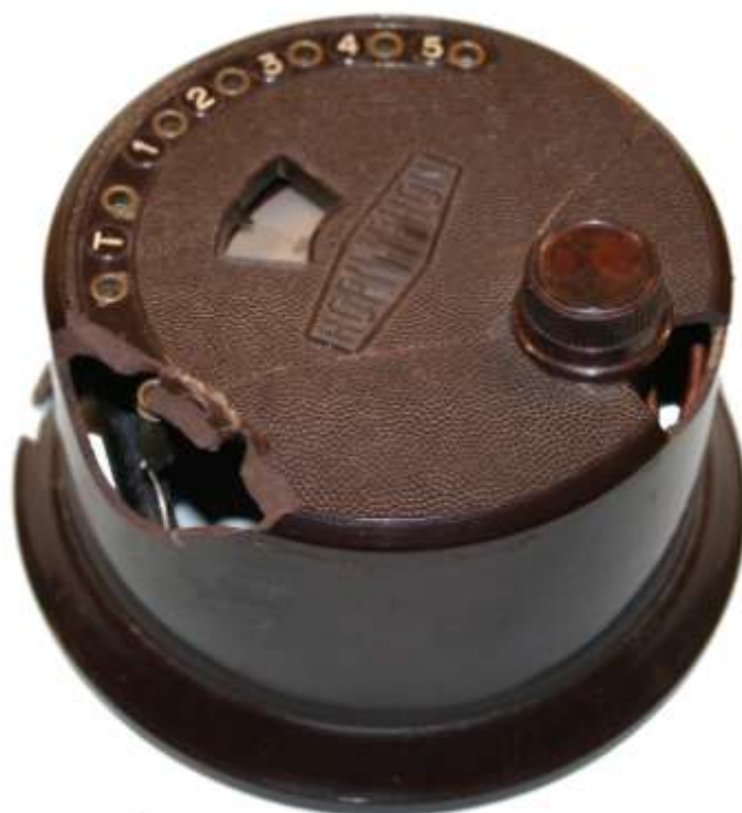
Gehäuse mit Schadstellen
