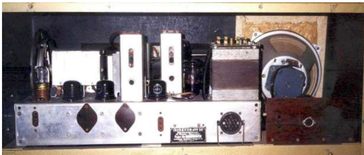
Innenansicht des MINERVA 499 SH - Umbau zum Hörempfänger
