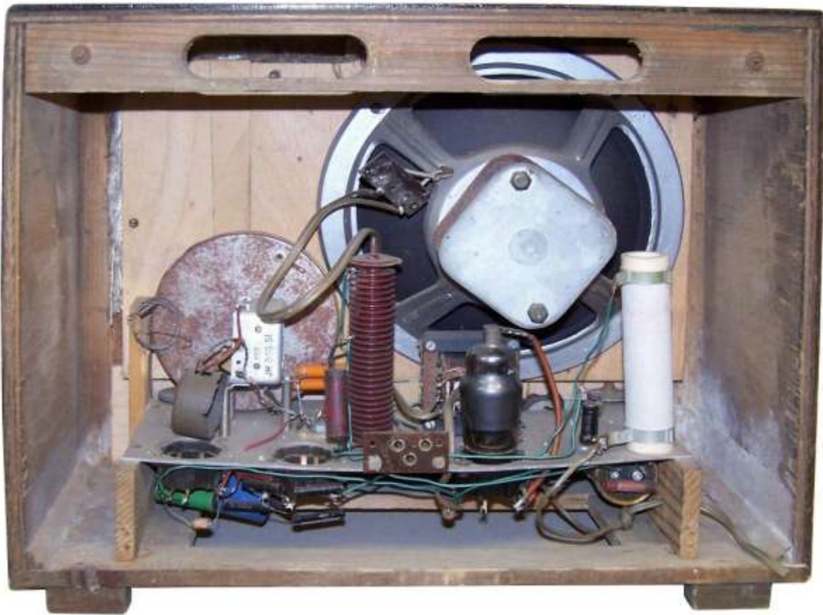
Innenansicht des Notgerätes von „RADIO BISKO Neulengbach“, das Chassis ist an der Hinterkante durchgebogen, weil es dort nicht abgekantet ist
