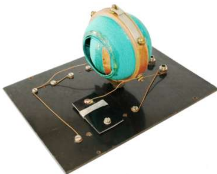
Ein Blick ins Innere auf das Variometer und auf den Kondensator
