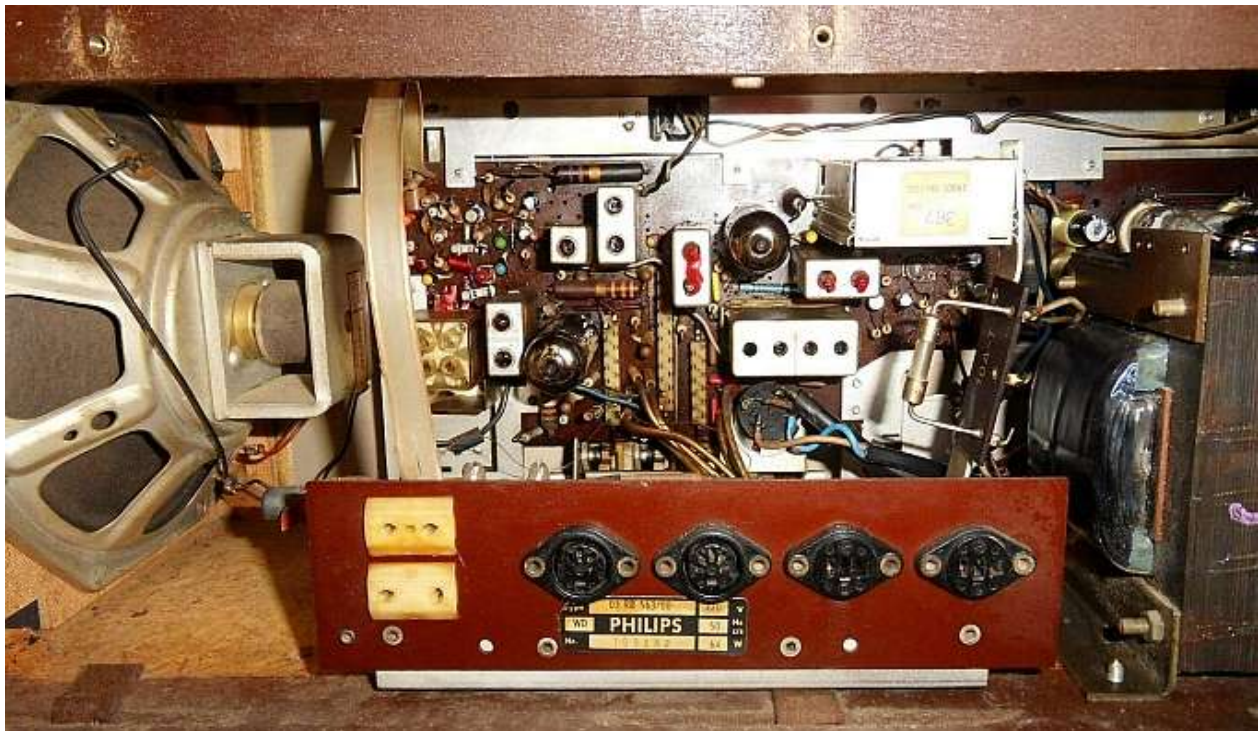
Detailansicht des Empfangsteiles mit dem rechten Lautsprecher
