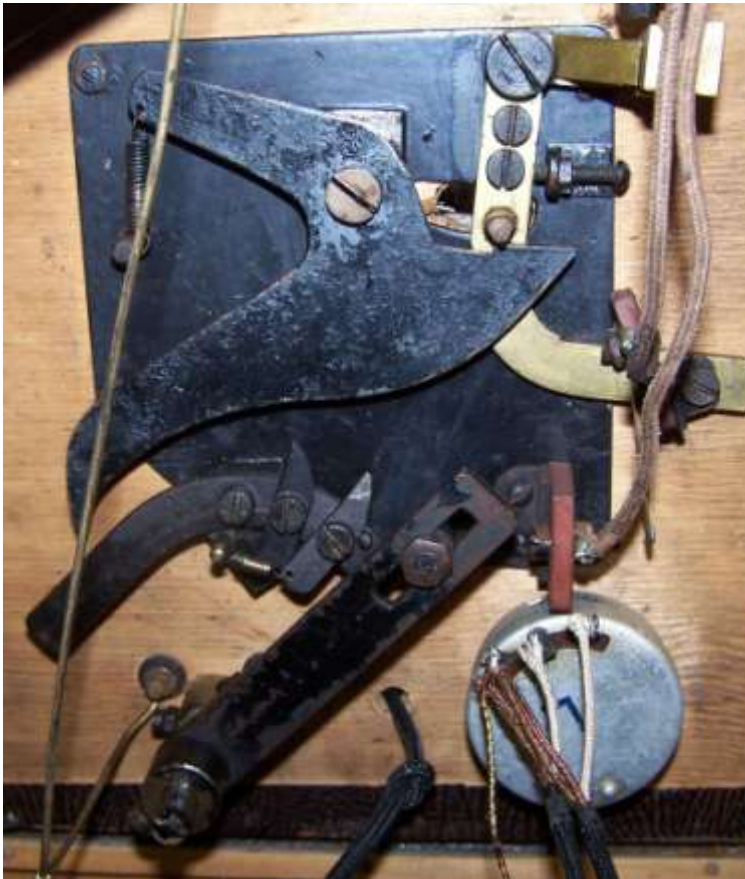
Die Mechanik des Plattenspieler und das Lautstärke-Potentiometer, rechts der Motor und das darauf angebrachte DUAL-Logo
