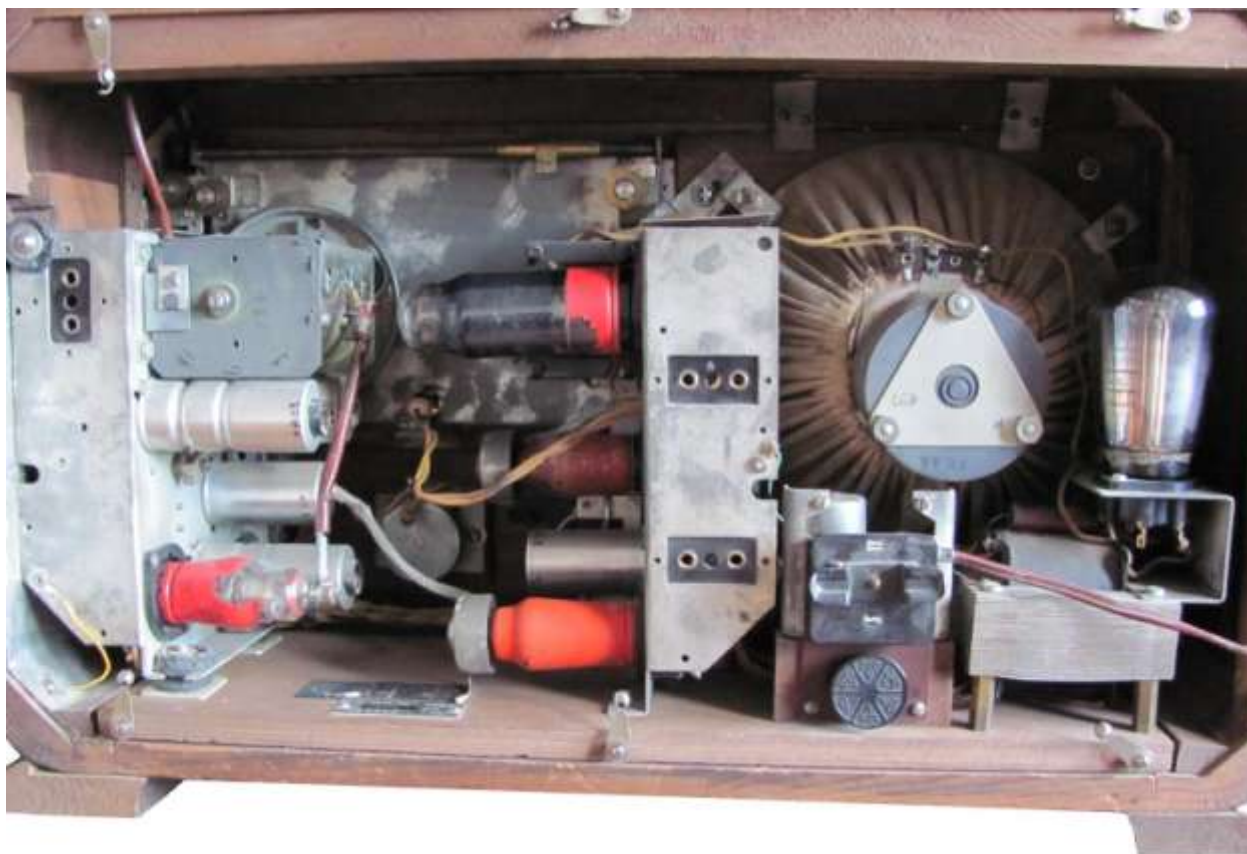
Blick ins Innere des Gerätes. Links das HF-Chassis, rechts ZF und NF
