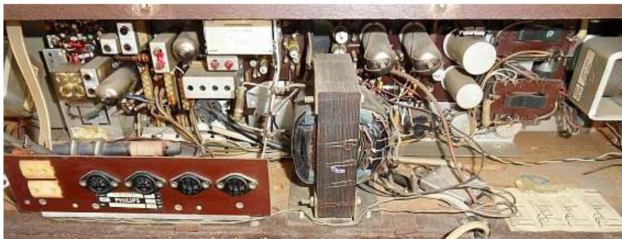
Ein Blick ins Innere des Gerätes zeigt die typische PHILIPS-Bauweise, nicht übersichtlich, aber kostensparend
