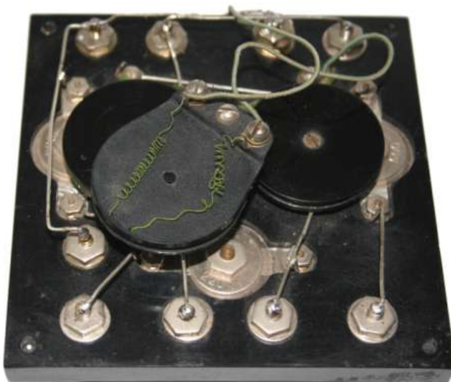
LEOSON Detektorapparat, Unterseite der Bedienplatte
