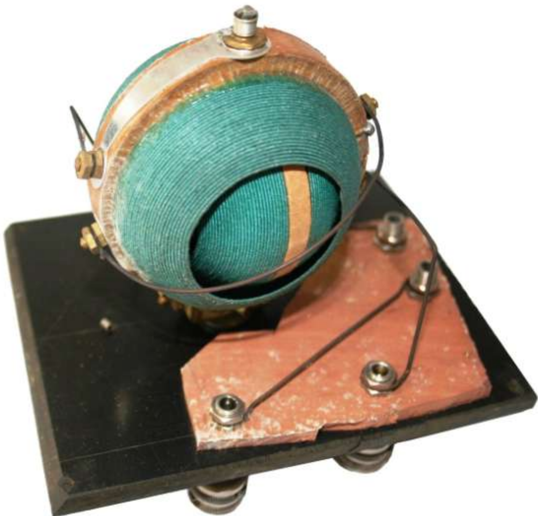
ROSENMAYR Detektorapparat, Innenaufbau mit Kugelvariometer
