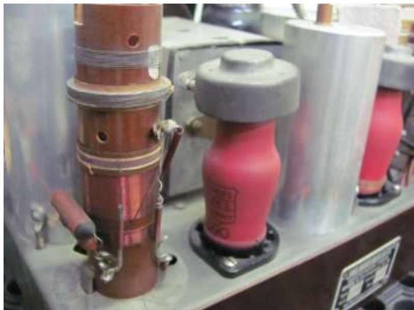
RADIONE 439 U, Oszillatortspulen und Wickeltrimmer
