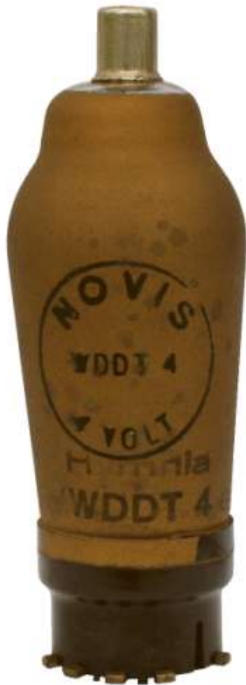
Abbildung 5: Charakteristische Hymnia-Beschriftung von Novis-Röhren
