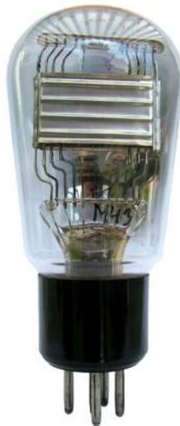
Abbildung 3: Novis 3SP4 mit Sator-Typenbezeichnung am Quetschfuß
