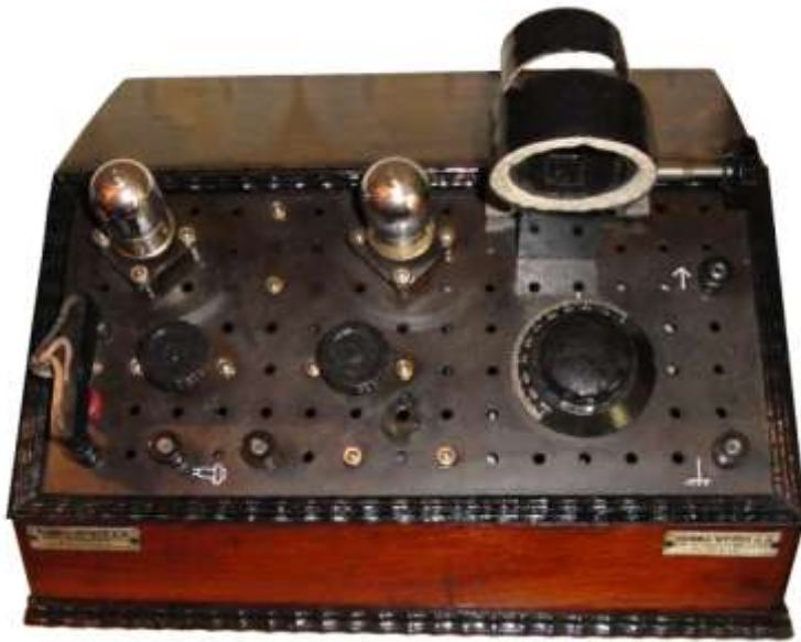
ER-HA 2 Röhren Empfänger Type FV2 auf 1/2 Platte mit 15 x 32 cm, fertig montiert, Geräte Nr. 555, beschildert: „Kobra-Werke A.G., Bauerlaubnis Telefunken“ und „Kobra-Werke A.G., Wien XI Sechsschimmelgasse 4 Tel 67-4-86“ [Sammlung & Foto: Pils]
