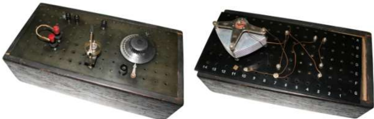
ER-HA Detektor-Empfänger, um 1924/25 (Sammlung Macho). Links: Ansicht von außen, rechts: Innenansicht der Schaltplatte
