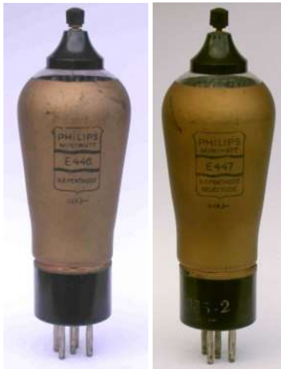
PHILIPS HF-Pentoden E446 (links) und E447 (rechts)
