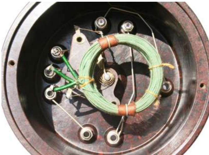
ZEUS „Elite“-Detektorapparat, offen
