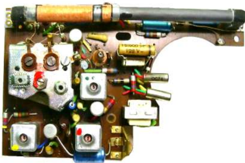
RADIONE Boy 6, Bauteileseite
