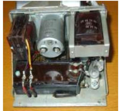
spannung wurde erst im Gerät erzeugt. Das verschraubte Blechchassis wird abgedeckt durch eine tiefgezogene Aluminiumhaube. Charakteristisch sind zwei große Elektrolytkondensatoren 16  $\mu\text{F}/250\text{V}$  der Firma Jahre in einem verschraubten Preßstoffgehäuse. Die aufwendige Verdrosselung folgt der Telefunken-Vorschrift. Der **Wechselrichter ha** (untere Bildreihe) baut auf der Schaltung seines Vorgängers auf, leitet aber direkt aus einer der beiden
