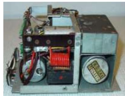
Anodenspannungswicklungen des Transformators durch separate Gleichrichtung über einen Sirutor eine negative Gittervorspannung ab. Durch diese Kunstschtung konnte der vorhandene Transformator weiter verwendet werden. Offenbar war er für die erhöhte Sendeleistung ausreichend dimensioniert. Wesentlich kompaktere Elkos 700  $\mu\text{F}/6\text{V}$  und 16  $\mu\text{F}/250\text{V}$
