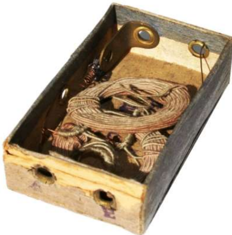
RADIAX, Detail mit Antenne- und Erdbuchse
