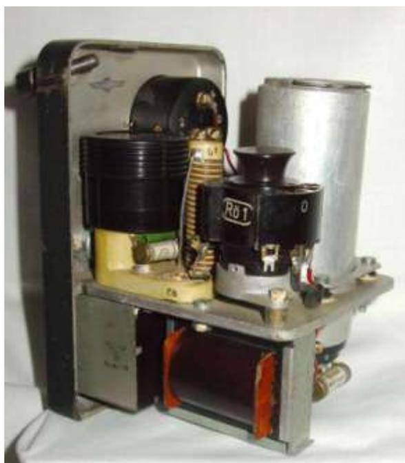
Gerätenummer 24b-628 und 24b-629 aufgeführt, von deren tatsächlicher Existenz ist aber nichts bekannt. An der Buchse des Fprüf.f (Bild rechts) werden Heiz- und Anodenspannung zur Verfügung gestellt. Durch eine Schaltklinke wird ein Ersatzwiderstand an der Anodenspannung abgeschaltet, um die zusätzliche Belastung (ca. 4 mA) durch den Empfängerprüfer auszugleichen.
