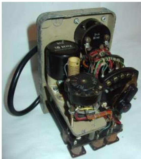
Zu ihm gehört das **Prüfgerät PrKIFuSpr d/K**, dessen Bezeichnung auch auf den bei Lorenz entwickelten Kleinfunksprecher K (20 bis 40 MHz) hinweist, von dem es aber bei Kriegsende nur wenige Muster gegeben hat. Konstruktiv
