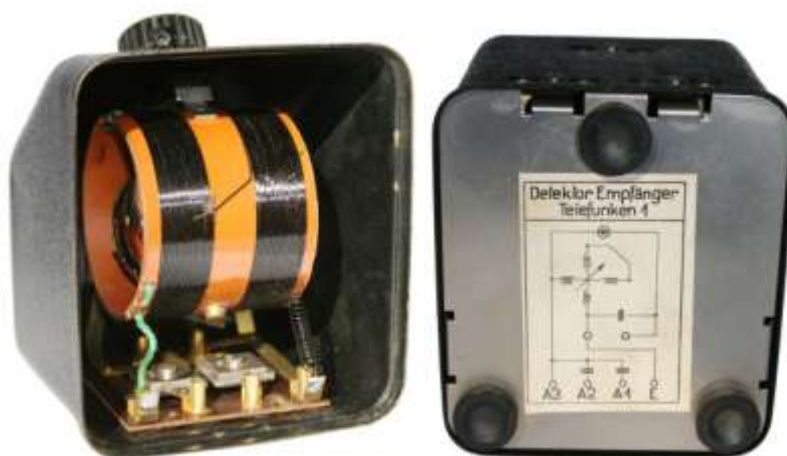
Telefunken T1, Innenansicht und Bodenplatte mit Schaltung
