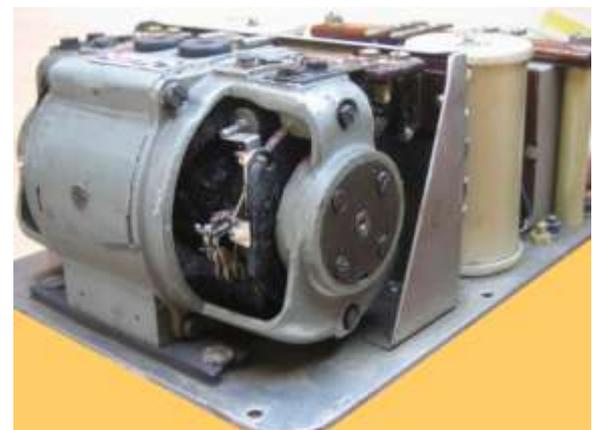
Der ganz wesentliche Unterschied zu den späteren Typen ist aber die Montageplatte für Maschine und Entstörung, die von unten in den Gehäuserahmen eingeschraubt und mit Bitumen abgedichtet wird.
