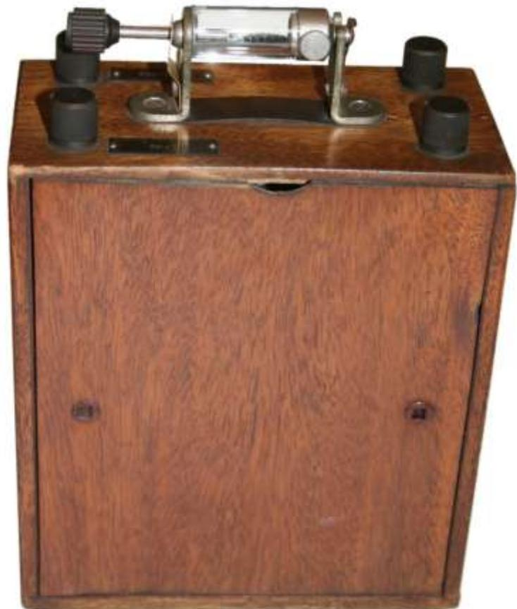
**KAPSCH Detektorapparat, Rückseite**
