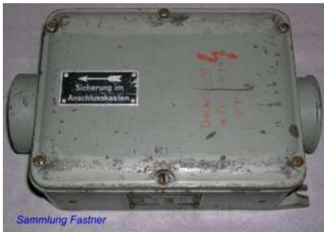
Entstörkondensatoren 22 nF sind in die Lagerschilde der Maschine eingebaut. Die 15 A-Sicherung befindet sich im Anschlusskasten, worauf ein Schild auf dem Deckel hinweist.
