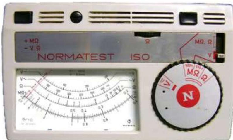
**Analog zeigendes Isolationsmessgerät mit zwei unterschiedlichen Messspannungen.**
