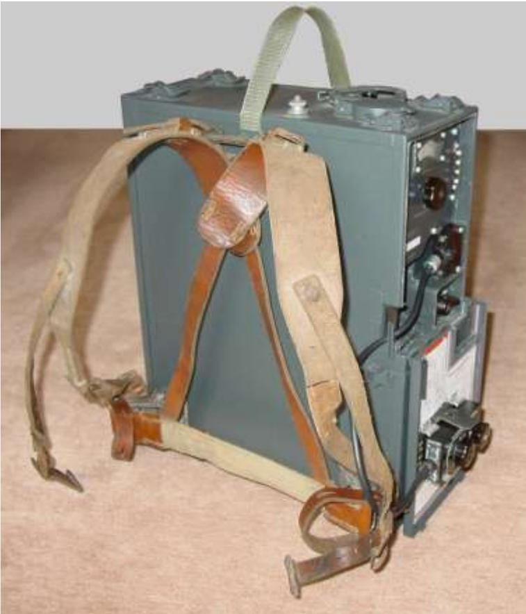
Zwei verstellbare Riemen an der Rückenstütze umfassen das Koppel und halten das Gerät am Rücken fest. Zwei Riemen auf der Brustseite werden in Ösen am Koppel (oder an der Patronentasche) eingehängt und übernehmen so einen Teil der Rückenlast. Von den beiden Haupttrageriemen ist einer fest, der andere mit Ring und Karabinerhaken teilbar.
