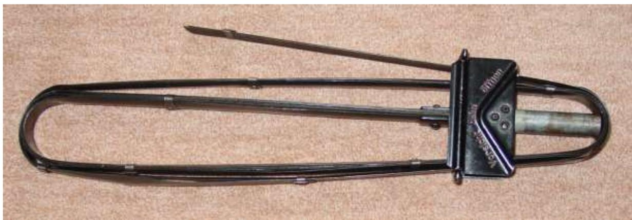
Je nach Notwendigkeit wird die Marschantenne als alleinige Antenne auf die Antennenspule i aufgesetzt, was sich für Funkbetrieb während des Marsches empfiehlt, oder sie wird durch Antennenstäbe ergänzt, was die Wirksamkeit erheblich verbessert.
