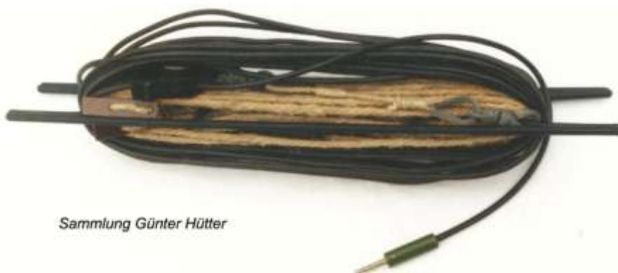
Die Bestandteile von Antenne und Gegengewicht werden auf Drahtspeln gewickelt. Zwei Abspannseile, verschiedene Zwischenstücke, Isolatoren und Abfangleinen ergänzen die Antenne. 4 Heringe gehören zur Grundausrüstung des Funkgerätes mit Stabantenne.
