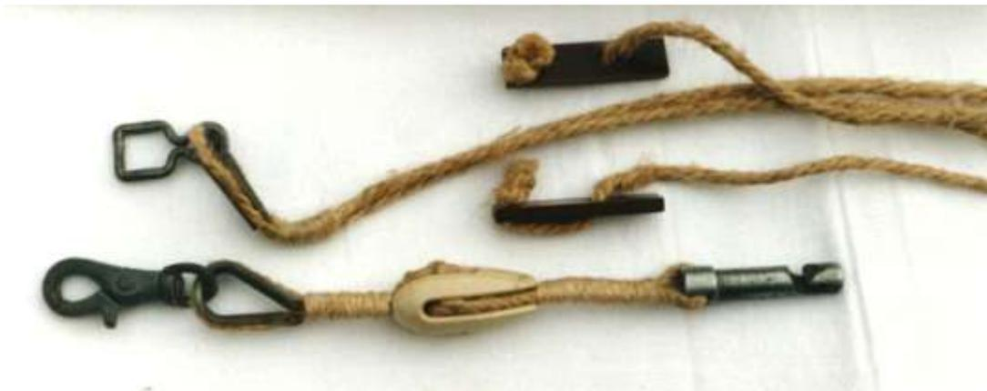
Die langen Abspannseile für den Mast (im Bild oben) werden mit einer Öse in den Hakenbolzen der Isolatorleine eingehängt, der seinerseits durch das Loch des obersten Maststabes hindurch gesteckt wird.
