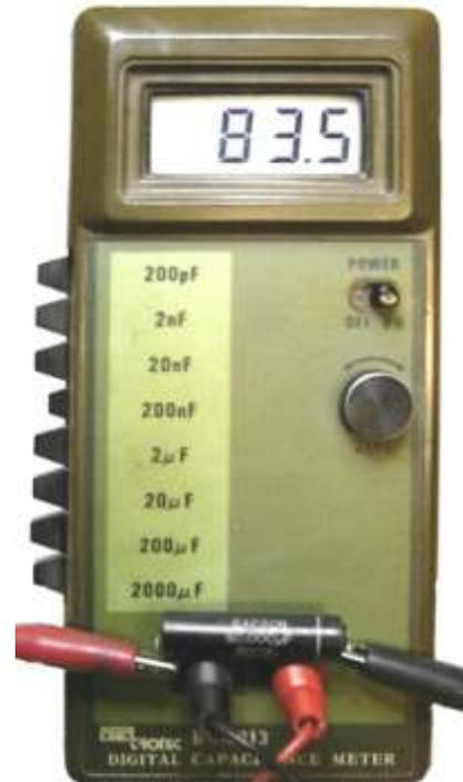
**Modernes, direkt anzeigendes digitales Kapazitätsmessgerät. Der Prüfling (50 nF) zeigt einen Wert von 83,5 nF, ist also defekt.**
