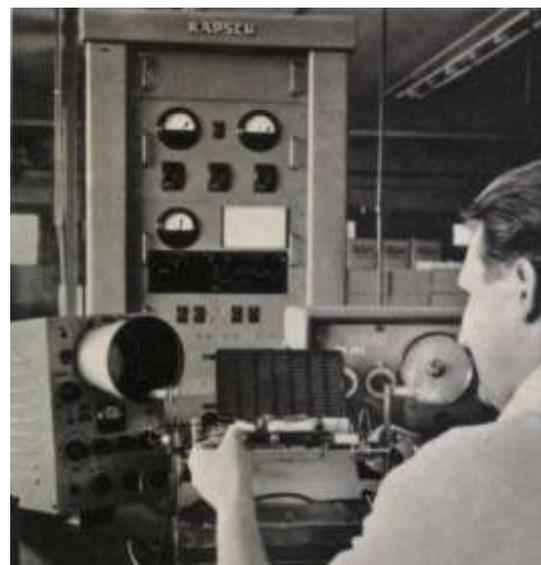
Im Prüffeld versorgt eine zentrale Sendeanlage jeden Prüfplatz mit einer messbaren Antennenspannung. Jedes Gerät wird auf Höchstleistung kontrolliert.
