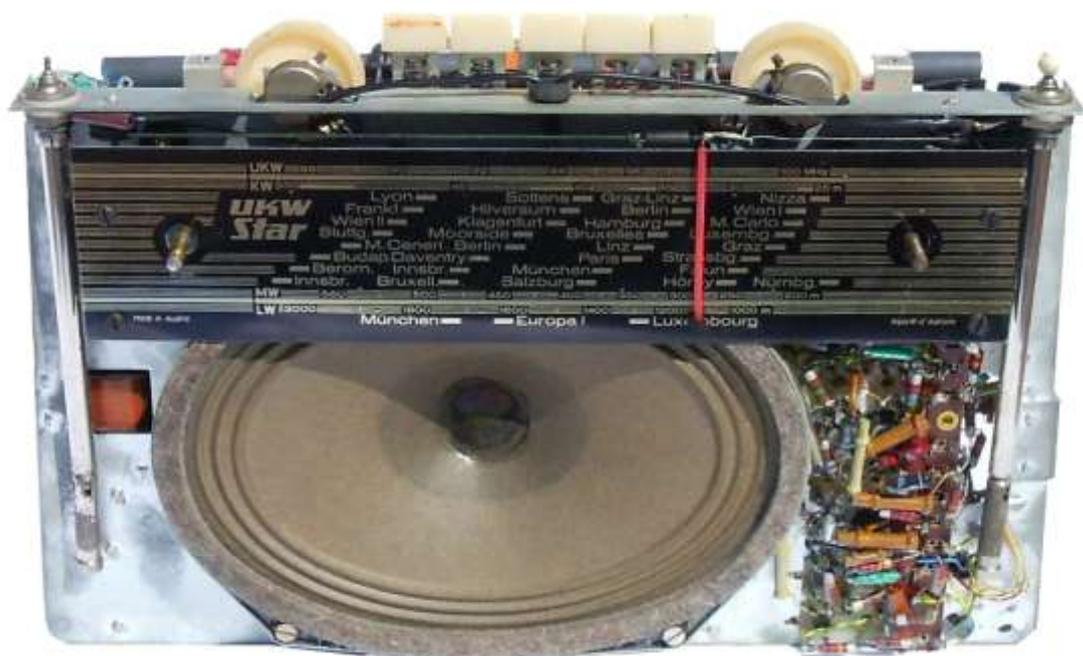
Deshalb sollte man im Falle des Ersatzes eines defekten Transistors lieber auf die nächste Generation ausweichen (z.B.: AF124, AF125,...), die sich als absolut zuverlässig erwiesen hat. Diese Transistoren sind in ihren Abmessungen kleiner und haben kürzere Anschlussdrähte, was den direkten Einbau in Geräten mit fliegender Verdrahtung erschwert. Aber mit etwas Draht und dünnen Bougierschläuchen sollte das keine Schwierigkeit darstellen.
