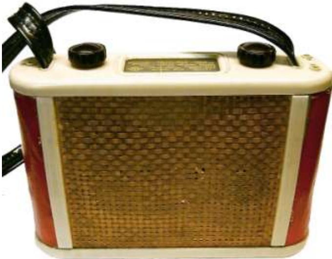
Äußerlich dem Gipsy 51 nicht unähnlich, zeigen sich doch einige gravierende Abweichungen: Das Gehäuseblech besteht nicht aus einem Stück, sondern ist in vier Teile zerlegt: Zwei gerade Stücke, die den Vorder- und Hinterteil bilden und mit Strohgeflecht bespannt sind. Zwei halbtönenförmige Seitenteile, mit rotem Wachstuch überzogen und für den Batterietausch abnehmbar. Die Skala weist natürlich nur einen Wellenbereich (nämlich MW) auf und der seitlich angebrachte Wellenschalter fehlt. Durch den
