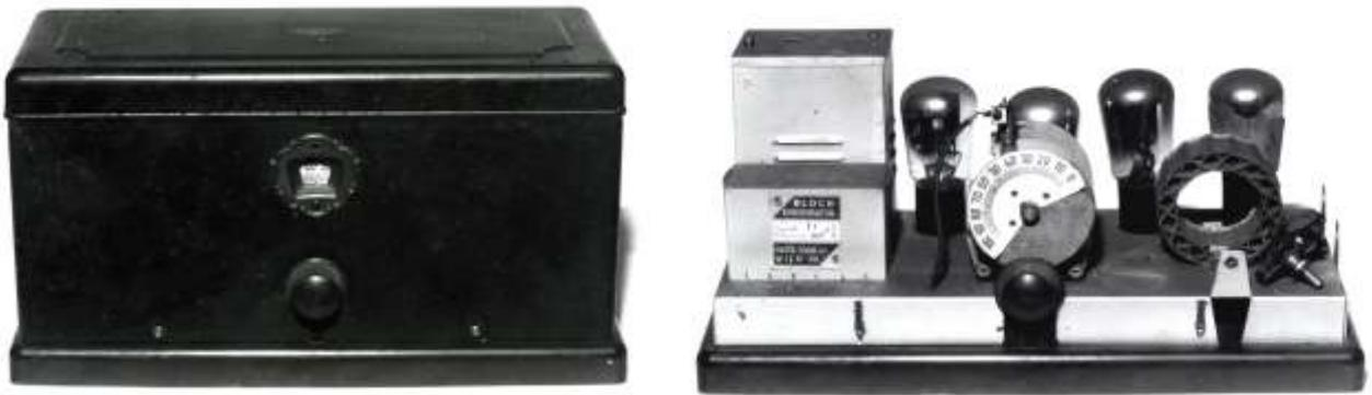
KAPSCH Tri-Electric W 3-Röhren-Empfänger
