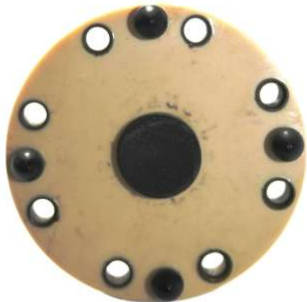
Ansicht des Detektors von unten mit eingesetztem Kristallhalter
