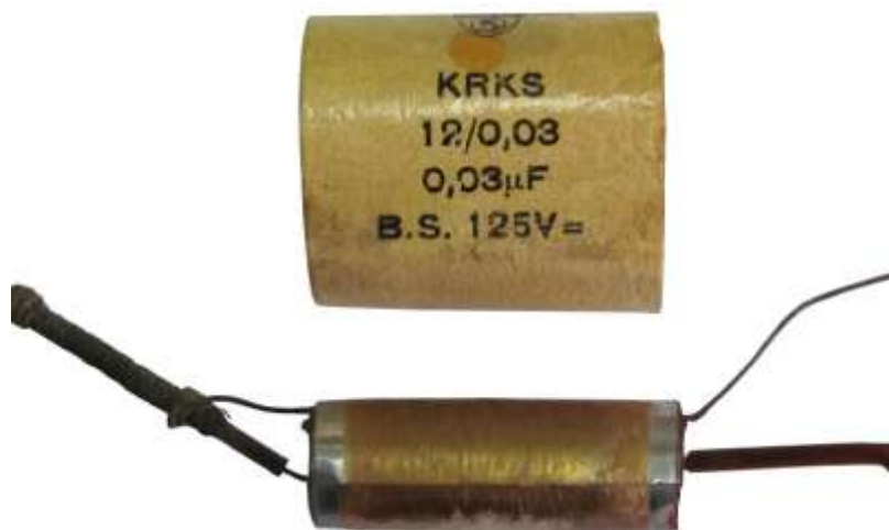
Der defekte Kondensator, geöffnet
