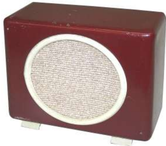
Bild des „Stic 100“ im Blechgehäuse, noch ohne Aufstellbügel
