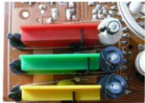
Bild rechts: Klassischer Reparaturfall: Zwei der drei Abstimmungs-seilspannräder sind gebrochen.
