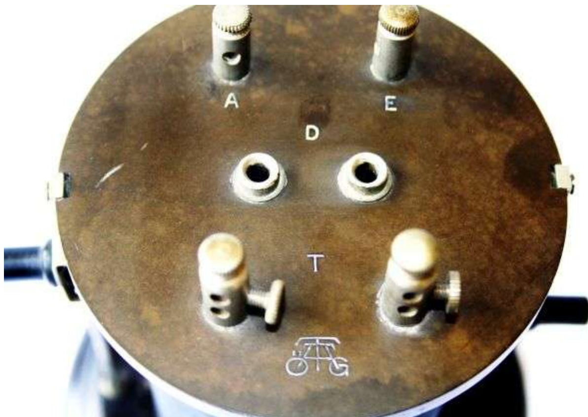
ÖTAG Detektorapparat, Details der Bedienplatte
