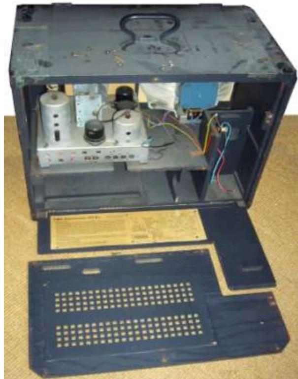
Er wird versorgt aus einer 90 V- oder 120 V-Anodenbatterie und einem Pertrix Heizelement 2306 (Elementgröße ENL).
