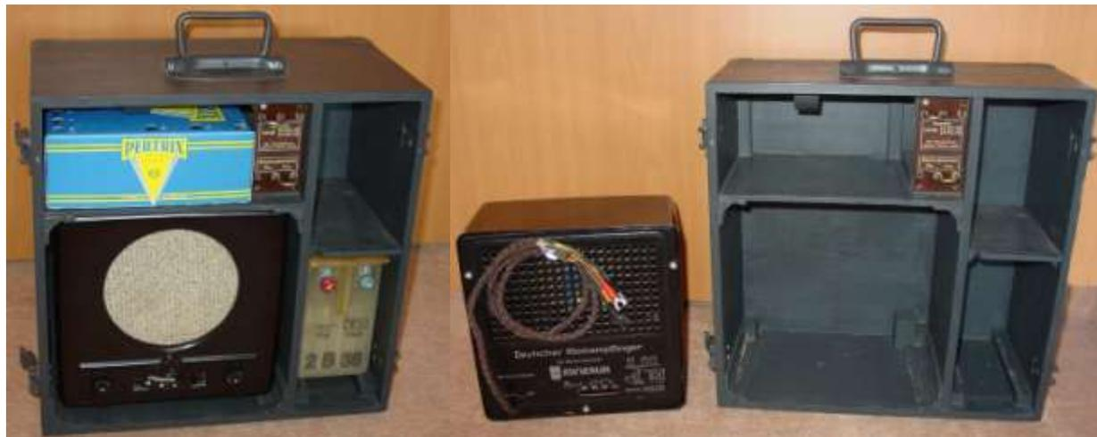
Anzahl verblüffend einfacher aber sinnvoller Einzelheiten. Da der Empfänger auch in den Kasten eingeschoben funktionieren soll, muß der Ein-Schalter an der Rückwand immer eingeschaltet sein. Ein Holzklötzchen im Gehäuse sorgt dafür, daß man das Gerät nur in eingeschalteter Stellung dieses Schalters ganz einschieben kann. Der Betriebs-
