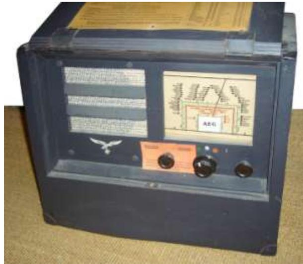
Sein Holzgehäuse hat einen aufklappbaren Deckel, der bei Betrieb flach auf dem Gehäuse aufliegt. Mit den Abmessungen 470 x 390 x 280 mm und 11,5 kg Gewicht ist der Empfänger vergleichsweise groß und schwer.
