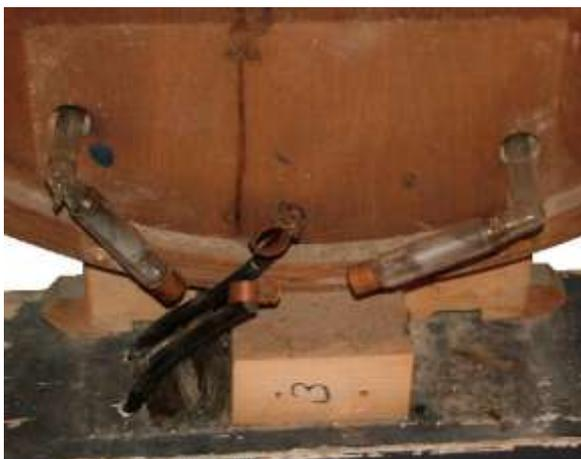
**Detailansicht: Elektroden der Neonröhre**
