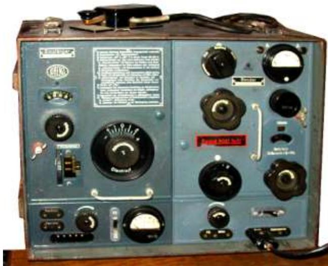
spruchsvollere Technologien für militärisches Gerät einzusetzen. Lorenz führte mit dem Funksprechgerät O die **Blockbauweise** mit Baugruppen und Teilen aus **Elektron-Spritzguss** ein und löste damit die Chassis-Bauweise unter Verwendung von Aluminiumblech, Pertinax und Holz hinter einer massiven Frontplatte ab. Das neue Gerät bestand aus vier miteinander verschraubten und durch Steckverbinder elektrisch verbundenen Baugruppen, die jeweils einen Teil der Frontplatte und des
