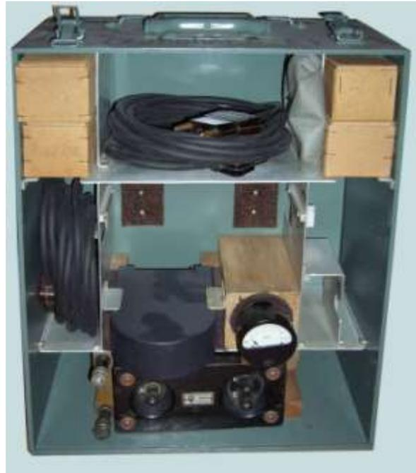
1941 wurde der **5 W.S.b** mit eingebauter Kunstantenne eingeführt. Der Hauptschalter erhielt dafür eine fünfte Schaltstellung „KA“, sonst wurde nichts geändert. Vermutlich war die Modernisierung lange geplant. Die Auflagepunkte und der freie Platz für die Kunstantenne waren, wie die Innenansicht des 5 W.S. zeigt, schon in den Geräten von 1936 vorhanden.
