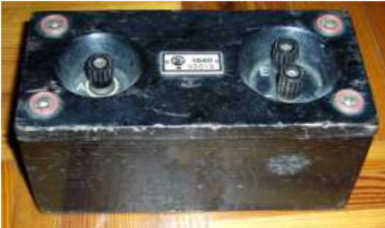
Zum Sender gehörte als Zubehör die **Kunstantenne KA 5**, mit der ein Abstimmen und Prüfen des Senders ohne die Antenne durchgeführt werden konnte. Mit anderem Zubehör, z.B. der Stationsuhr, Kabeln und Ersatzröhren war sie im **Zubehörtornister (S-E) Fu 21** (Bild rechts) untergebracht.
