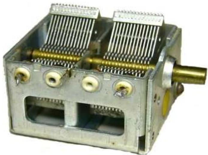
Ansicht eines Drehkondensators. Ausführung mit zwei gleichen Paketen
