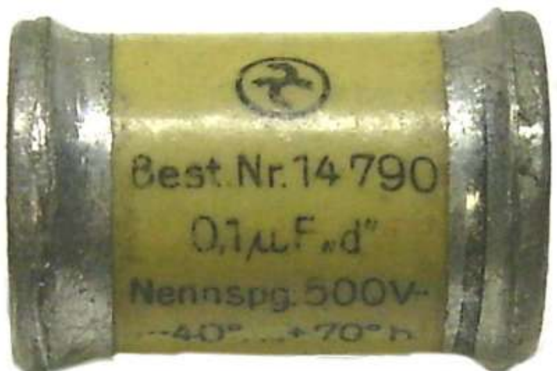
Sonderform des Rollwickelkondensators in tropenfester Ausführung
