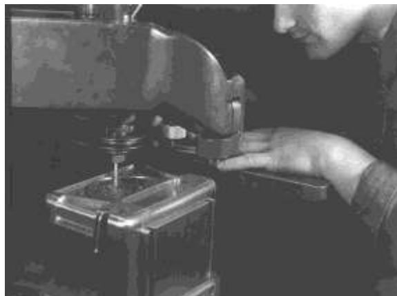
Fräsen der Formdurchbrüche
