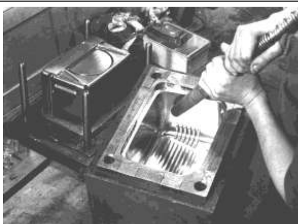
Letzte Reinigung der Stahlform
