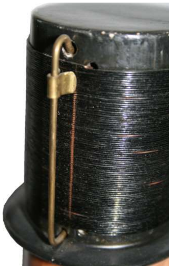
„Uncle Tom“, Detail der Spulenabstimmung
