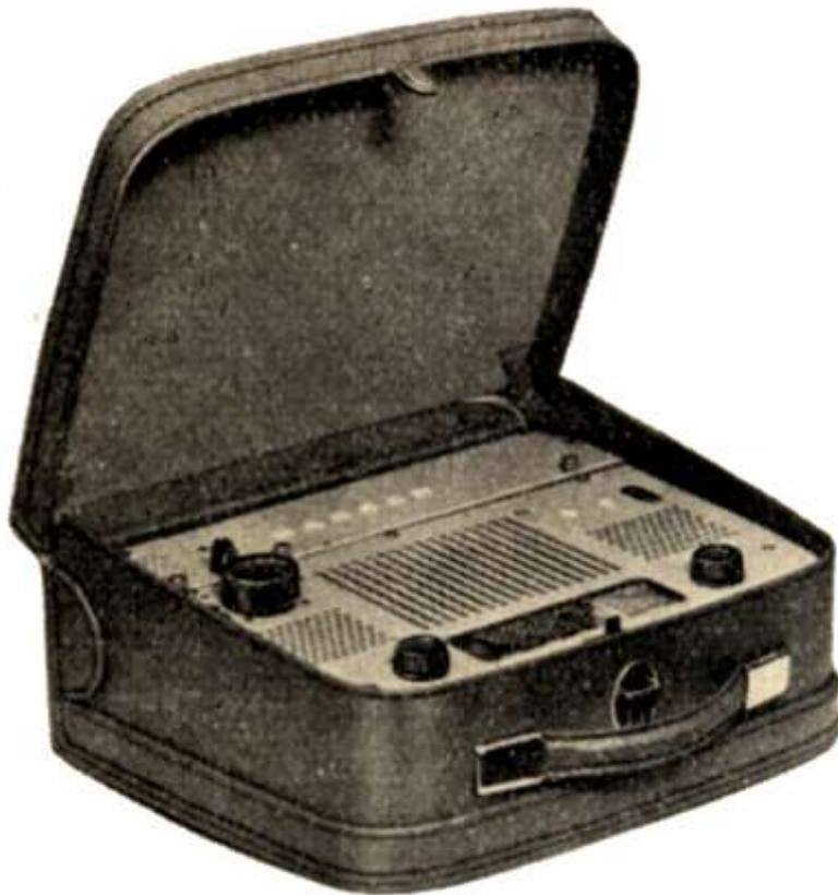
Der Empfänger selbst, wird als Vierröhren-Sechskreis-Super beschrieben. Der Rahmenkreis ist im Deckel untergebracht. Das Gerät empfängt MW und KW. Es kann an jedes Lichtnetz unabhängig von dessen Spannung und Stromart angeschlossen werden. Der Koffer ist mit einem schweinslederartigen Nylonbezug versehen. Das Gewicht inklusive Batterien wird mit 3,10 kg angegeben.
