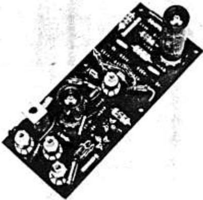
Bild 4. Decoder-Platine des „Stereo-Jupiter“ für einen Kanal mit NF-Verstärker.
